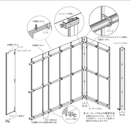
※フラットパネル設置の際には天地逆にならない様にフラットパネル裏面の文字「フラットパネル」の向きに注意して下さい。
